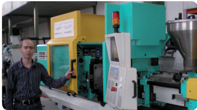
Dipl.-Ing. Matthias Hartmann an der Spritzgussmaschine des Lehrstuhls, für welche die auf der hauseigenen CNC-Fräse gefertigten Werkzeuge von ihm mit SolidWorks konstruiert wurden.
